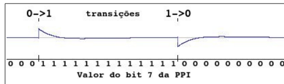
Figura 3.1. Pulsos gerados pelo clique da porta C da PPI.
